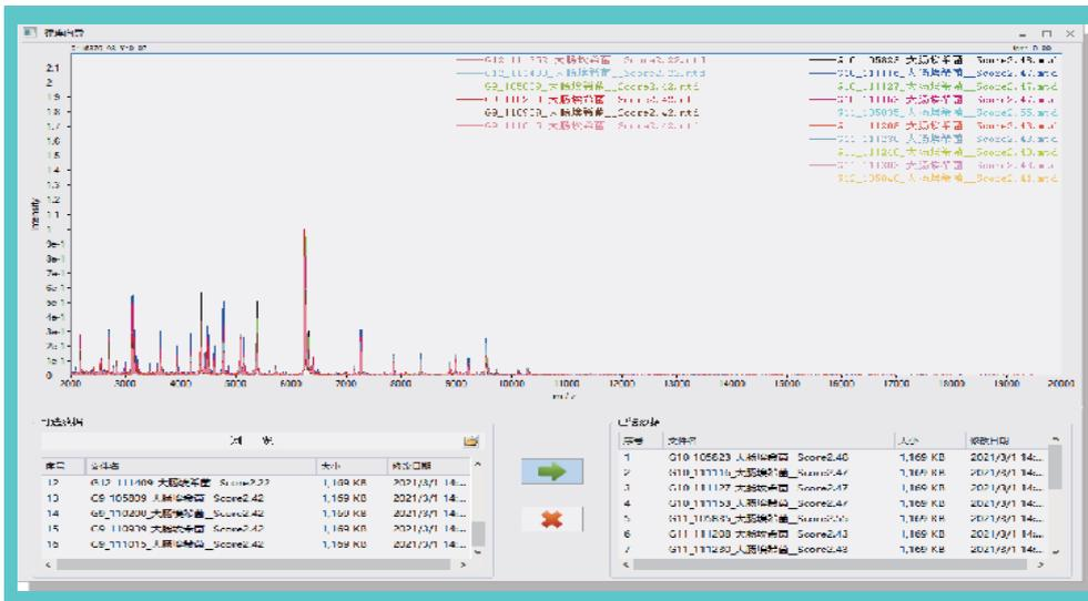
O sistema pode identificar e corrigir de forma inteligente os  $\pm 10$  Da do deslocamento do espectro com busca sincronizada durante o processo. E o resultado da detecção será obtido dentro de 0,1s.
